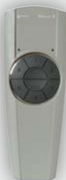
Programowalny pilot sterujący służy do zdalnego sterowania oświetleniem, roletami, wentylatorami, ogrzewaniem, itd.
